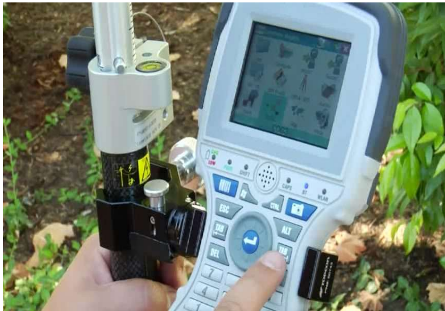
21-сурет Кинематикалық әдісте өлшем жүргізу
